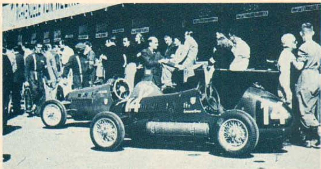
*La Cistalia D 46 davanti ai box del circuito di Bremgarten a Berna (1948). Da notare il serbatoio laterale in alluminio che permetteva di compiere anche una distanza da Gran Premio senza fare rifornimento.*
