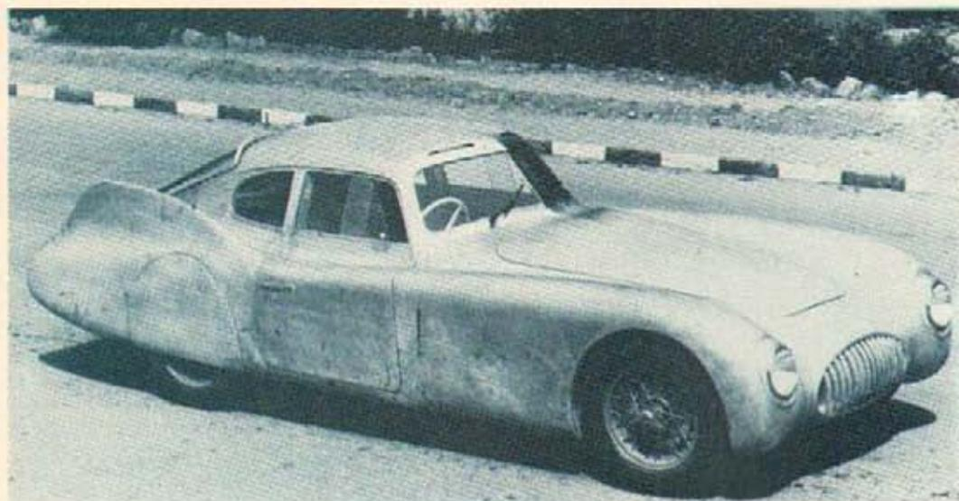
Il secondo telaio Cisitalia sport venne munito di questa carrozzeria aerodinamica con grandi pinne posteriori. Da notare anche l'arco sottile sopra il lunotto posteriore (come la BMW 3.0 CSL «alata» attuale) che serviva per guidare i filetti d'aria. La carrozzeria venne pure disegnata dall'ing. Savonuzzi, però Alfredo Vignale la realizzò ritoccando il disegno
